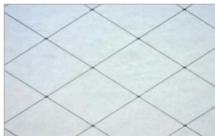
Imbedded Mesh ( \leq 5 OPS, T\% \geq 90\% @ 400-2 \mu m) Cu:CuO or Nb:Hf
